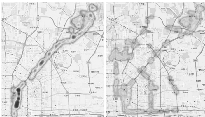
Wizualizacja gęstości pojazdów na poszczególnych odcinkach – po lewej wynik dla początkowego układu tras, po prawej – dla tras znalezionych za pomocą kwantowego wyżarzania (im ciemniejszy obszar, tym większa gęstość pojazdów).
