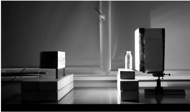
Fot. 2. Układ doświadczalny do badania wpływu własności butelki i wypełniającej ją cieczy na skupianie promieni świetlnych.
