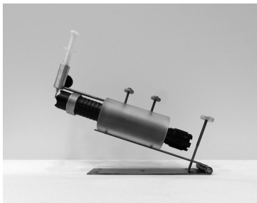
Fot. 3. Bardziej uniwersalna wersja mikroskopu zbudowana z zastosowaniem zawiasu i przystosowana do zamocowania wskaźników laserowych o różnych rozmiarach. Widoczny jest tutaj niebieski wskaźnik laserowy o mocy około 1 W.
